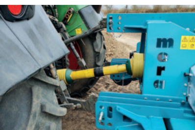
Inclinaison faible de l'arbre de transmission
