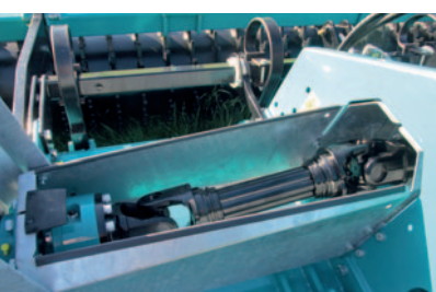
Arbre d'entraînement de grande dimension avec embrayage synchronisé
