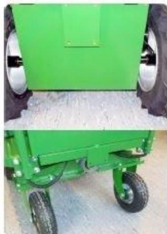
Console de montage avant & arrière pour le montage de la lame à neige, de la remorque, etc.
