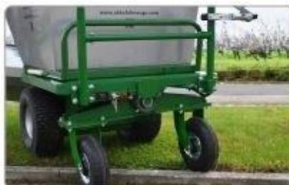
L'essieu oscillant permet de compenser les inégalités. Les roues motrices ont toujours de la traction sur le sol.
