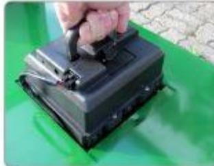
Réglage continu de la vitesse par le levier du pouce ainsi que sélection du sens de la marche (avant/arrière) par interrupteur inverseur
