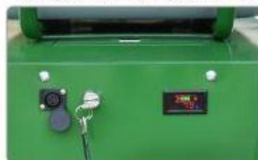
Bloc de commande avec clé, prise de charge et écran LED avec affichage du niveau de charge
